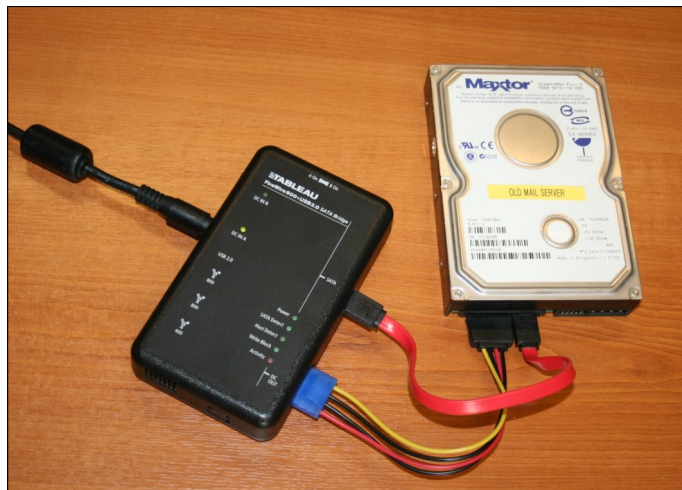
Przenośny write-blocker połączony z twardym dyskiem. Fot. ErrantX, commons.wikimedia.org
