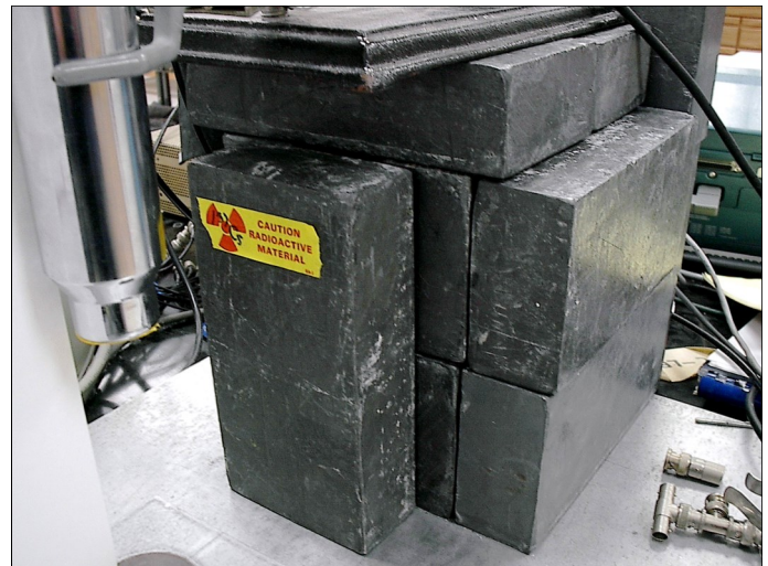
Na zdjęciu: płyty ołowiane używane jako osłona próbki radioaktywnej. Fot. Changlc, commons.wikimedia.org
