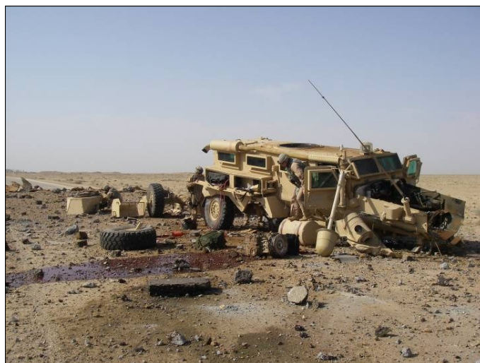
Transporter opancerzony Cougar po eksplozji IED w Iraku. Załoga nie odniosła trwałych obrażeń. Fot. U.S. Military, commons.wikimedia.org
