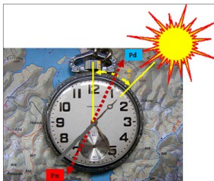
Rys. nr 3: Ustalenie kierunku stron świata za pomocą słońca i zegarka. Źródło: opracowanie własne.
