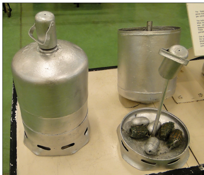
Butla na propan-butan dostosowana do konspiracyjnego transportu broni (IDF Museum, Tel Awiwi, fot. K. Kubiak).
