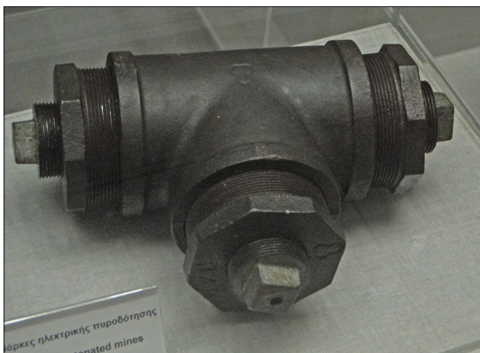
Improwizowany ładunek wybuchowy z elementów rur kanalizacyjnych przygotowany przez bojowników EOKA. Fot. K. Kubiak
